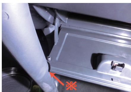
ロールバー取付後のグローブボックスオープンイメージ（※部ロールバーと干渉無き事）
