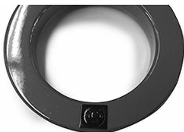
①牽引フックを90°以上可倒させてフロントバンパーとの接触箇所に③クッションを貼りつける。
