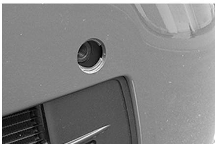
フロントバンパ左側にあるアイボルト取り付け用のリッドを取外す。
