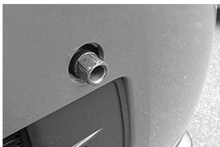
②アダプター（ショート）のねじ部に防錆、かじり防止のグリスを塗布し、車両に取付ける。
